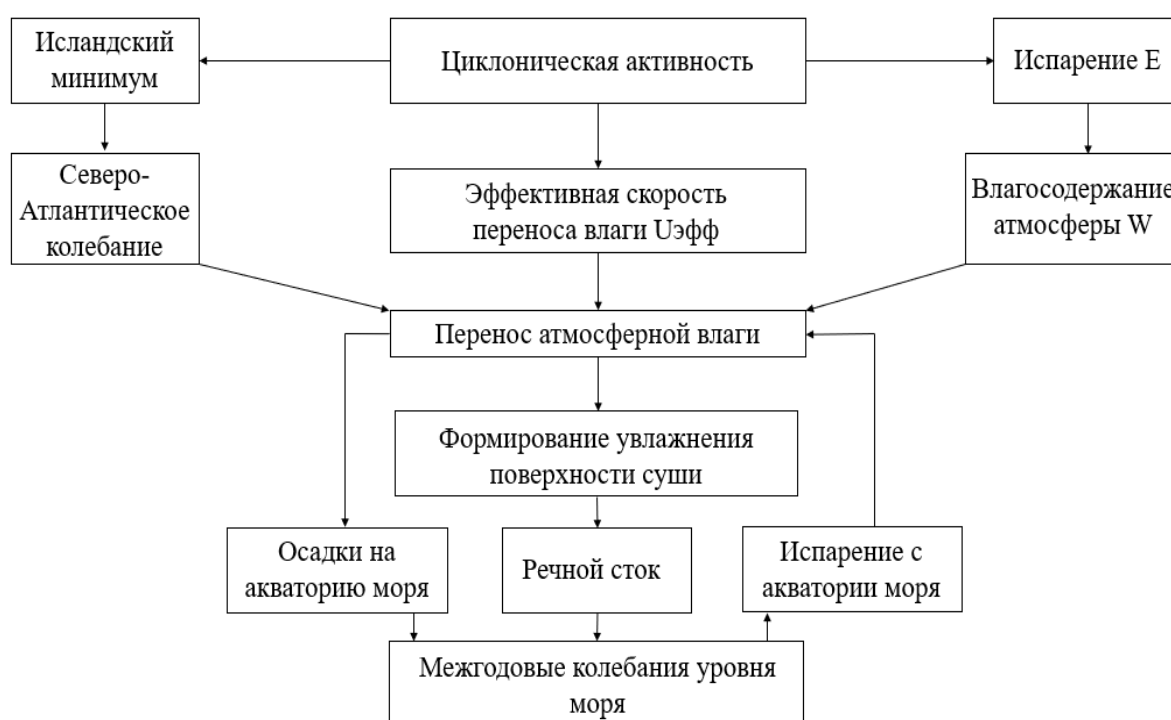
Рис. 5. Генетическая схема формирования межгодовых колебаний уровня Каспийского моря (Малинин, 1994; Водный ..., 2016). Fig. 5. Genetic scheme of formation of interannual fluctuations of the Caspian Sea level (Malinin, 1994; Water balance ..., 2016).
