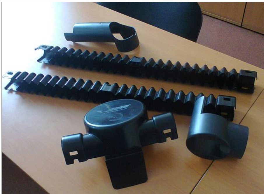
Фото 1. Птицезащитные устройства (фото О.С. Гринченко). Photo 1. Bird diverters (photo by O.S. Grinchenko).
