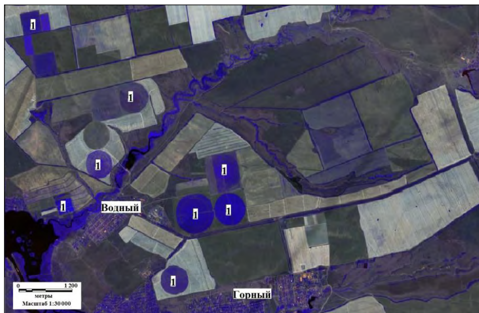
Рис. 7. Выделение орошаемых массивов на изображении космического снимка со спутника Sentinel-2 (27.07.2020) в сочетании каналов 2, 3, 4 (зеленый, красный, ближний инфракрасный; Горохова и др., 2021). Условные обозначения: 1 – орошаемые массивы. Fig. 7. Irrigated areas (1) on a Sentinel-2 image obtained on 27/07/2020, channels 2, 3 and 4 (green, red and near infrared; Gorokhova et al., 2021).
