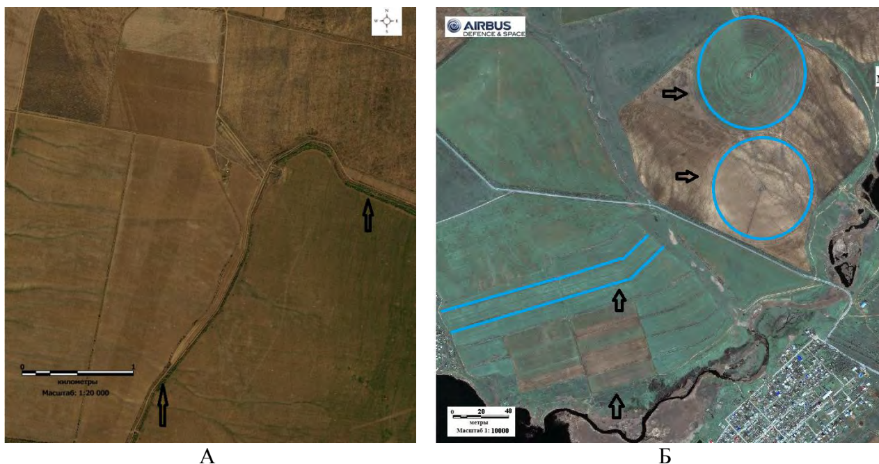
Рис. 4. Оросительные каналы на космических снимках: А – головной оросительный канал; Б – круговое орошение и временные оросители, отмеченные на космических снимках с портала Yandex.ru и Pliedas (18.04.2019) на территории орошаемых земель Волгоградской области. Fig. 4. Irrigation canals on satellite imagery: А – mail canal, Б – pivot irrigation and temporary sprinklers on the satellite images taken from Yandex.ru and Pliedas (18/04/2019) in the irrigated lands of the Volgograd Region.
