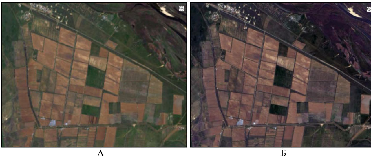
Рис. 3. Изображение орошаемых земель со спутника Landsat OLI-8 (01.05.2016): А – мультиспектральное, Б – полученное в результате совмещения мультиспектрального изображения с панхроматическим каналом. Fig. 3. A – multispectral image of irrigated lands obtained from Landsat OLI-8 on 01/05/2016, B – combination of a multispectral image and a panchromatic channel.
