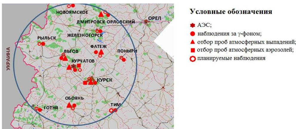
**Рис. 4.** Расположение пунктов радиационного мониторинга в 100-км зоне вокруг КуАЭС.
