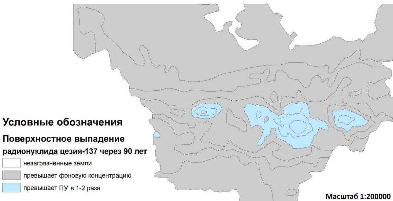
**Рис. 19.** Карта техногенной нагрузки (плотность поверхностного выпадения  $^{137}\text{Cs}$ ) спустя 90 лет после аварии на ЧАЭС. **Fig. 19.** Map of anthropogenic load (density of surface  $^{137}\text{Cs}$  deposition) 90 years after the Chernobyl Accident.
